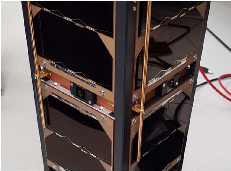
**Imagen 10. Detalle celdas solares Facsat1. Fuente FAC**
